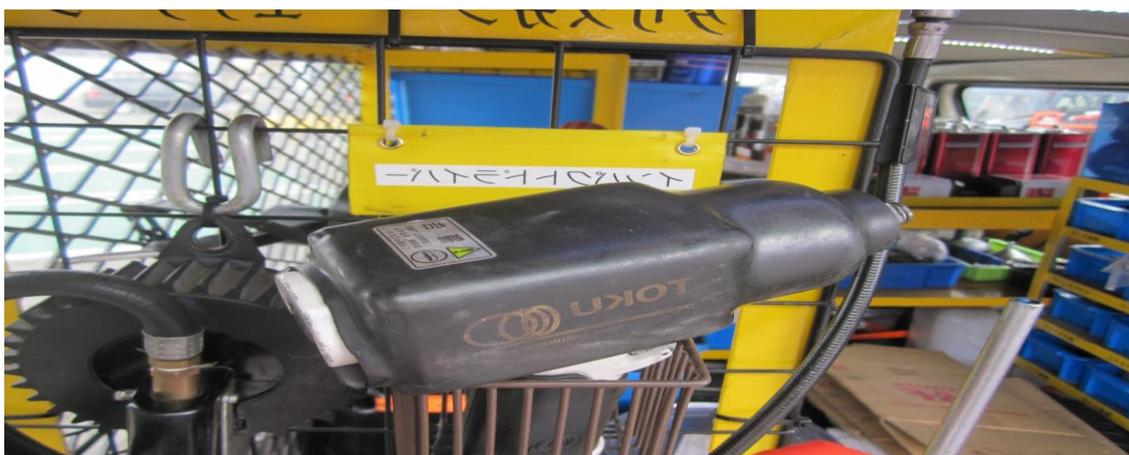
取付台を加工しインパクトドライバー置場を設置。
