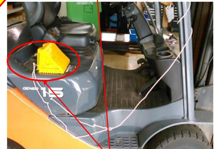
研修車両を移動する際、固定されている輪止めを車両のエンジンフードに載せていましたが、固定置場が無く足元に置いたりしていたので、エンジンフードに表示を付け車両を移動する時に定位置に置くようにしました。
